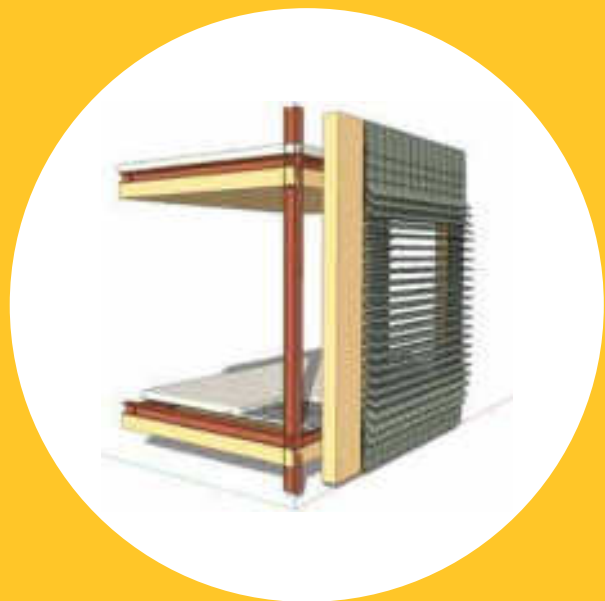
Détail axonométrique - Façade filtre
